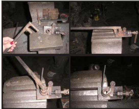
Foto 1.23 Proceso de curvado para piezas pequeñas
