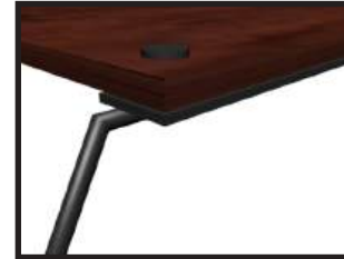
Fig 2.10 Utilizacion de remache
